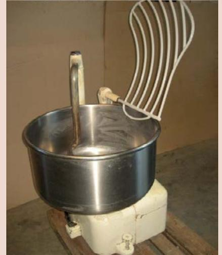
*Knetmaschine mit Gitter-Abdeckung*
